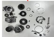
コンプレッサを構成している部品は電気自動車用の方が多い
